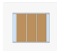
L'application **Vitré bord à bord** double vitrage permet de créer des espaces où la transparence et la luminosité sont optimisées. Elle consiste en des modules vitrés collés sans couvre-joint; les vitrages étant assemblés par un système de collage invisible. Les parclozes reçoivent des vitrages de 10 à 12mm d'épaisseur. Ce concept propose également un départ sur cloison sans poteau et sans usinage.
