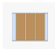
L'application **Plein acoustique** est composée de modules pleins toute hauteur recevant quatre peaux pour une performance acoustique parfaite. L'aspect reste identique à la cloison pleine toute hauteur classique. Une double lisse réglable permet de rattraper les faux niveaux et de prendre les cotes des remplissages en cours de chantier (gain de temps).
