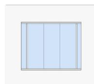
L'application **Plein bord à bord** permet de créer des cloisons parfaitement lisses sans structure aluminium visible. Elle consiste en des modules pleins avec des panneaux apposés bord à bord sans couvre joint. La mise en oeuvre s'effectue de manière très simple grâce à un système de clips inox. Les modules reçoivent des panneaux mélaminés de 12mm d'épaisseur.
