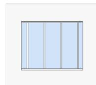
L'application **Plein toute hauteur** est composée de modules pleins double face avec couvre-joint. Ils reçoivent des panneaux BF13 revêtus ou des panneaux mélaminés de 12mm d'épaisseur. Le remplissage est complété par une laine de verre de 70mm. Une double lisse réglable permet de rattraper les faux niveaux et de prendre les cotes des remplissages en cours de chantier (gain de temps).
